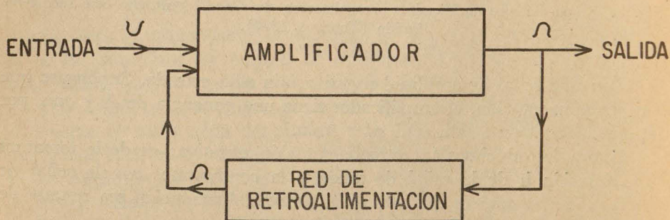
Fig. 5. Diagrama de bloque de un amplificador con ciclo de retroalimentación. (Mann y Garfinkel, 1968).
